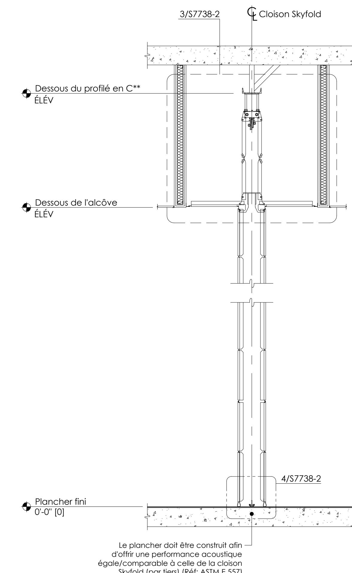
**C | ÉLÉVATION - CLOISON ABAISSEÉE**
