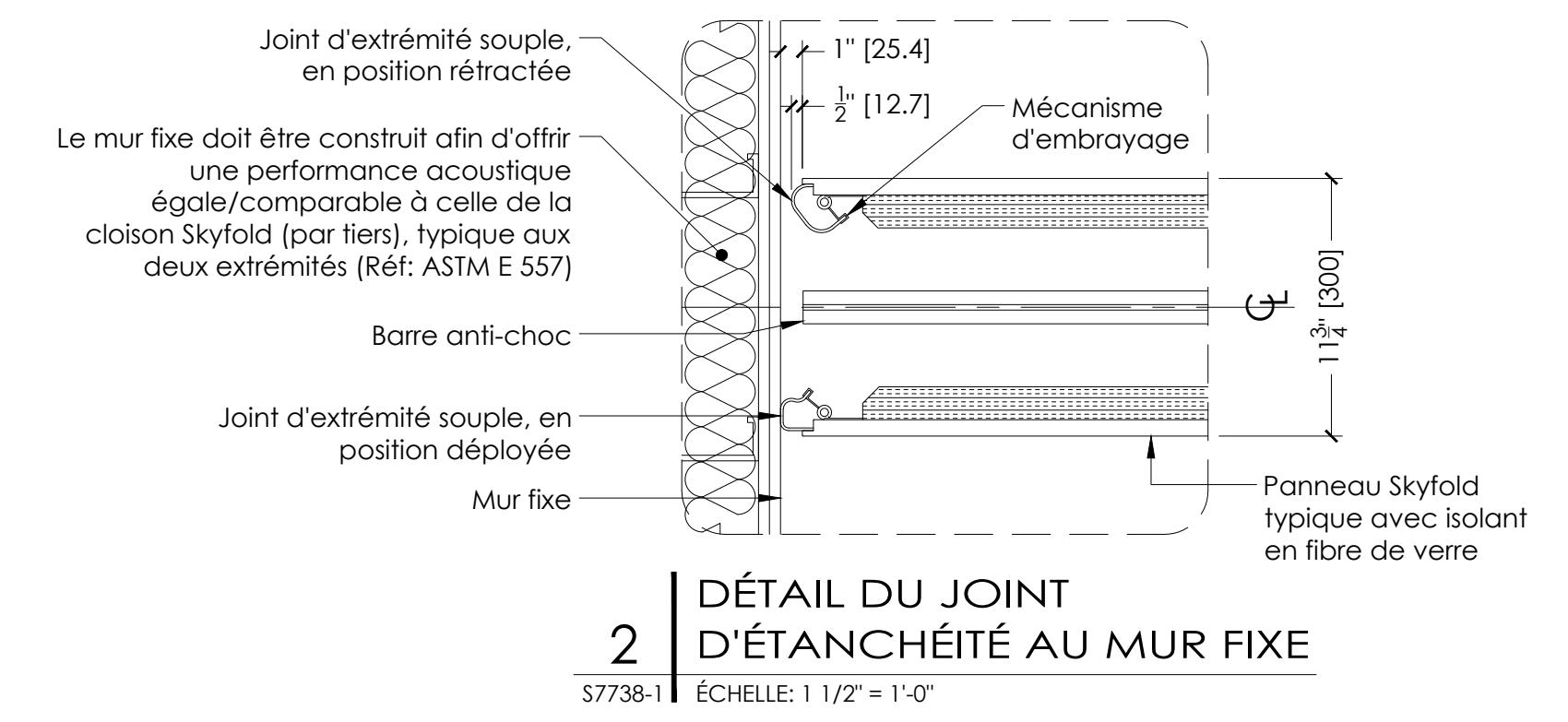
**2 | DÉTAIL DU JOINT D'ÉTANCHÉITÉ AU MUR FIXE**
