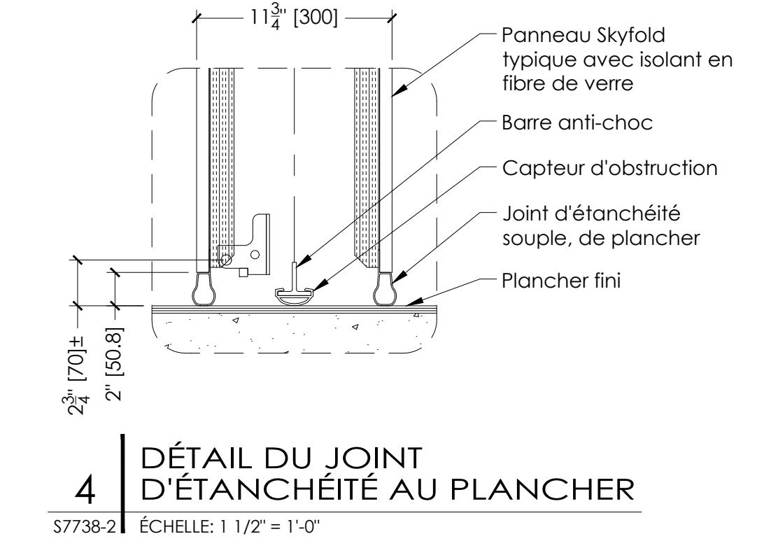
**4 | DÉTAIL DU JOINT D'ÉTANCHÉITÉ AU PLANCHER**
